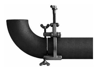
Para el centrado y tensado preciso de tubos sin limitación longitudinal, así como de tubos acodados, bridas, piezas en T, piezas de reducción y otras piezas de conexión en tubos. El trabajo puede realizarse sin necesidad de ningún ayudante. Puede accederse a la soldadura desde cualquier lado. El diámetro del tubo se ajusta con precisión mediante tornillos de mariposa.
