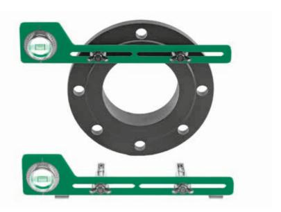
Nivel de burbuja de transportador ajustable y pernos de ajuste móviles. Los pernos de ajuste encajan en los agujeros de la brida con todos los diámetros corrientes, por lo que las bridas que deben soldarse se orientan de forma precisa. Puede leerse y ajustarse fácilmente el ángulo y la inclinación sin necesidad de ningún cálculo. Material: aluminio anodizado.
