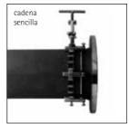
Para el centrado y tensado de tubos largos sin limitación longitudinal, así como de tubos acodados, piezas en T, bridas, piezas de reducción y otras piezas de conexión en tubos y recipientes. Las cadenas de centrado exterior flexibles CENTROMAT® se adaptan a cada tipo de tubo y de recipiente. Pueden prolongarse o acortarse según se desee, cambiando simplemente los eslabones adicionales. Hay disponibles cinco modelos, así como un modelo de acero fino y de acero galvanizado.
