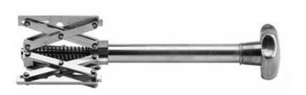
Para el tensado o centrado de los mismos diámetros o como dispositivo de tensado con un solo cuerpo extensible.
