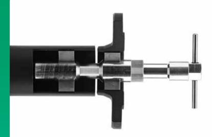
Con cuñas de sujeción. Un centrado y tensado rápidos, seguros y precisos de bridas, apoyos, anillos, etcétera, para tubos y recipientes cilíndricos en un proceso de trabajo. Ajuste automático del diámetro, incluso de diámetros muy diferentes. Las cuñas de sujeción también pueden suministrarse en VA por un precio adicional.
